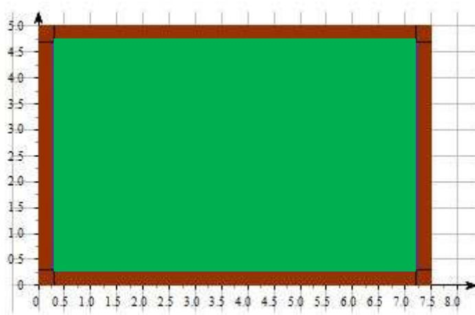
Les panneaux doivent être accolés les uns aux autres et une bordure d'au moins 30 cm de large (soit 0,3 m) doit être laissée libre. Donc on cherche à installer les 20 panneaux dans un rectangle de côtés 6,9 m et 4,4 m (en vert sur le dessin) puisque :
