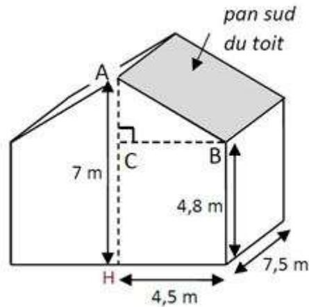
Le triangle ABC est rectangle en C avec  $BC = 4,5$  m et en supposant que le point C appartient au segment [AH] on a :  $AC = 7\text{ m} - 4,8\text{ m} = 2,2\text{ m}$  donc :
